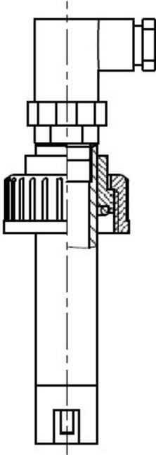
Die konduktiven Sonden EF2L und T mit integrierter Elektronik ET-473L und ET-473T werden zur Überwachung von Doppelrohrleitungen bzw. Befüllleitungen eingesetzt.
