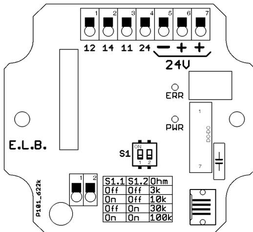
Der Netzanschluss des Messumformers ET-470.. ist auf die mit „+24V“ und „-24V“ bezeichneten Klemmen zu legen (20 ... 35VDC). Das Ausgangsrelais arbeitet in Ruhestrom Ausführung, Anschlussklemmen 11, 12 und 14.
