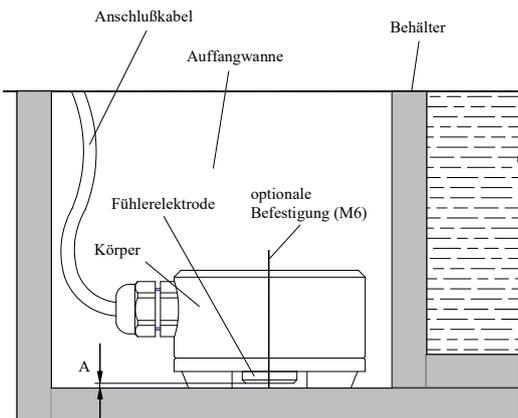
Die Leckagesonde EP... wird an der tiefsten Stelle des zu überwachenden Raumes ausgelegt. Dabei ist zum auf waagerechten Stand zu achten. Weiterhin wird darauf hingewiesen, dass sie gegen unbeabsichtigte Lageänderung zu sichern ist. Bei mehreren, in Reihe geschalteten Elektroden eines Raumes, darf der Prüf Widerstand nur an der letzten Elektrode der Kette eingebaut sein.
