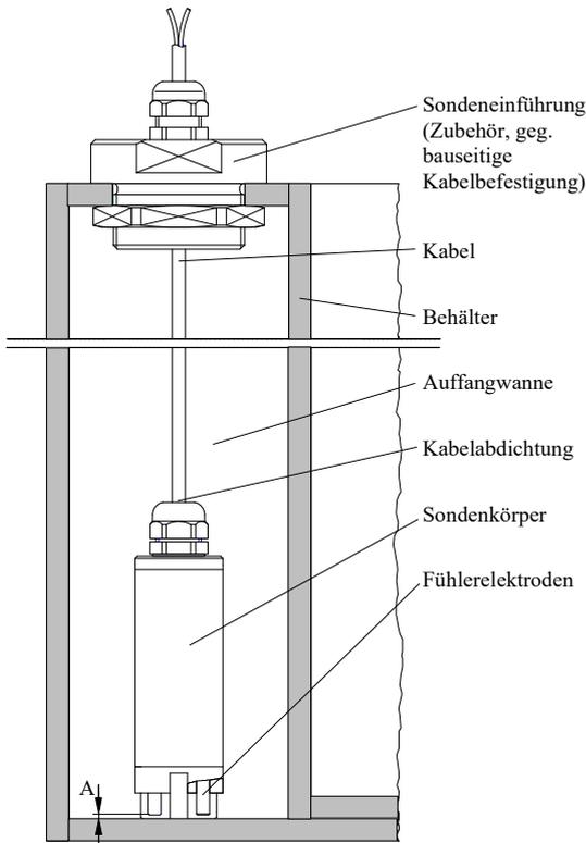
Die Leckagesonde ELH... ist von oben vorsichtig an der Leitung an der tiefsten Stelle, z.B. in die Auffangwanne eines Behälters abzusenken. Dabei ist zu beachten, dass die Leckagesonde bei Erreichen des Auffangwannenbodens in einer aufrechten Position den Boden gerade berührt. Die Leitung soll nach oben mit leichtem Zug geführt werden ohne durchzuhängen und andererseits ohne die Leckagesonde anzuheben.
