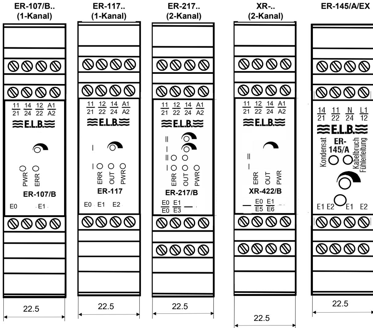
\* ERR = Leitungsfehler, OUT = Elektrode benetzt, PWR = Netz
