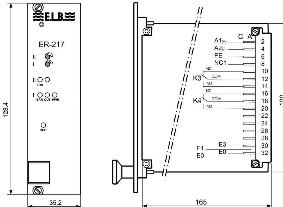
\* ERR = Leitungsfehler, OUT = Elektrode benetzt, PWR = Netz
