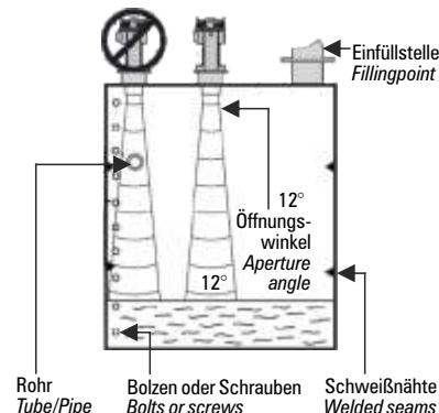
Die Kompakt-Ultraschall-Sonde muss so eingebaut werden, dass der Schall ungehindert und im rechten Winkel zur Materialoberfläche gelangen kann. In jedem Fall muss zwischen Sensorunterkante und maximal zu erwartendem Füllstand 250 mm Freiraum gewährleistet sein.
